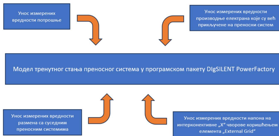
Слика 1: Шематски приказ креирања симулационог модела система за постојеће стање
